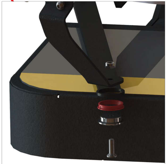
ABBILDUNG 11: MONTAGE TÜRBLECH AN PLEUEL
